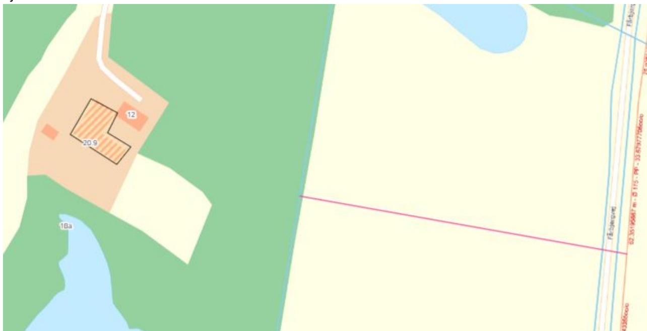
Figur 2 Nyt spildevandskloakeret opland 20.9, og planlagt ledningstrace
